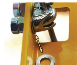
Mitta A vaihtelee vaijerilukoissa. Jos A on pieni, vaijerin sydän ottaa kiinni päteholkin reunaan ja Oplu-poljin ei pääse kunnolla ylä-asentoon. Mittaa A voidaan lisätä asentamalla prikot vaijerilukon kiinnitysruuvien alle. Vaijerilukko on syytä kiristää kaksoismutterilla, että vaijeri ei luista!
